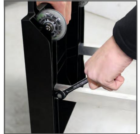
Die beiden Aluminium-Vierkantrohre in die entsprechenden Öffnungen der beiden Ständermodule führen. Anschließend durch die Blechschrauben (4,2 x 16 mm) mit einem 7er-Maulschlüssel fixieren.
